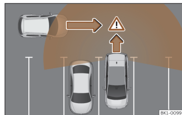
Fig. 154 Skematisk fremstilling av utmanøvreringsassistenten: Overvåket område rundt bilen som skal manøvrere ut.
