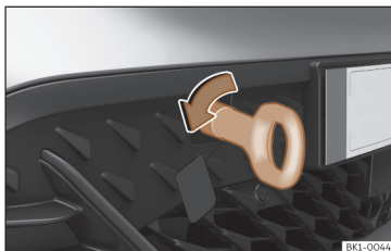
Fig. 184 På høyre side av støtfangeren foran: Slepekrok skrudd inn
