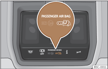
Fig. 44 I takkonsollen: Kontrolllampe for deaktivert frontkollisjonspute på passasjersiden foran.
