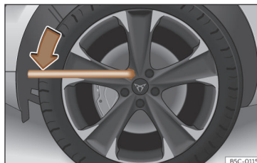
Fig. 200 Hjulskift: Løsne hjulboltene
