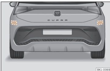
Fig. 121 Område bak bilen: Radarsensorenes områder.
