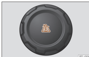
Fig. 192 Frontrom: Løkk på ekspansjonsbeholderen for kjølevæske.
