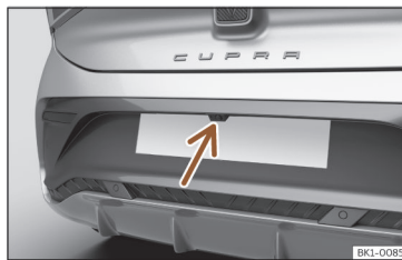
Fig. 123 I støtfangeren bak: Plassering av ryggekameraet.
