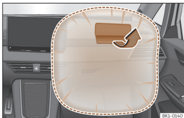
Fig. 42 Frontkollisjonsputen på passasjersiden er plassert i instrumentpanelet
