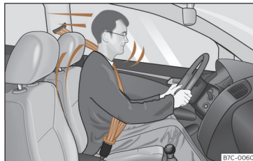
Fig. 33 En fører med riktig festet sikkerhetsbelte blir ikke kastet forover hvis bilen bråbremser.
