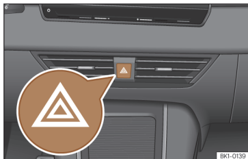
Fig. 60 Instrumentpanel: Bryter for nødsignalanlegget
