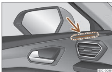
Fig. 176 Door: warning lamp
